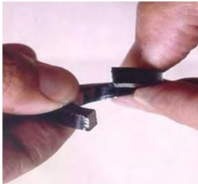
Abbildung 39: Helixaufweitung eines Rings
